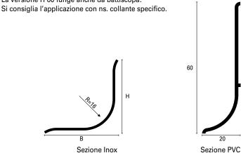
SANITEC IC è una linea di profili nata per l'esecuzione di raccordi igienici tra pavimento e rivestimento o tra due pareti, in particolare nel settore ospedaliero, chimico ed alimentare. Ideati per applicazioni su superfici già esistenti, quindi utilizzabili per ristrutturazioni e messa a norma di edifici pubblici costruiti precedentemente, perché rispondenti alle normative
